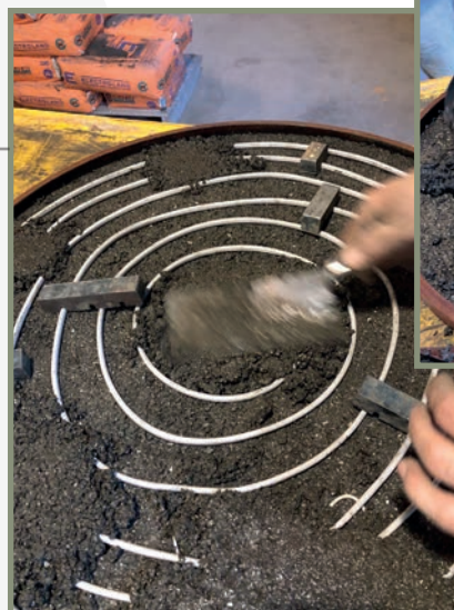
Stesura impasto refrattario e posa filo resistenza
