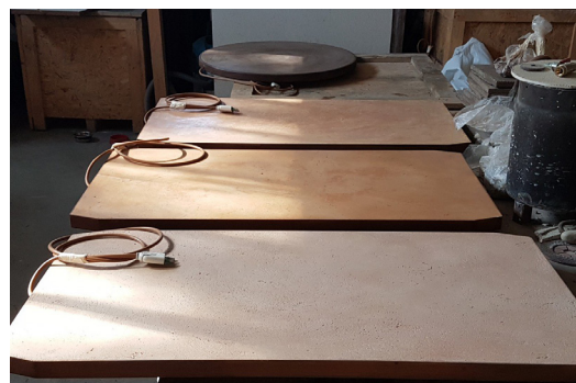
Pannelli radianti con rifiniture a base di calce
